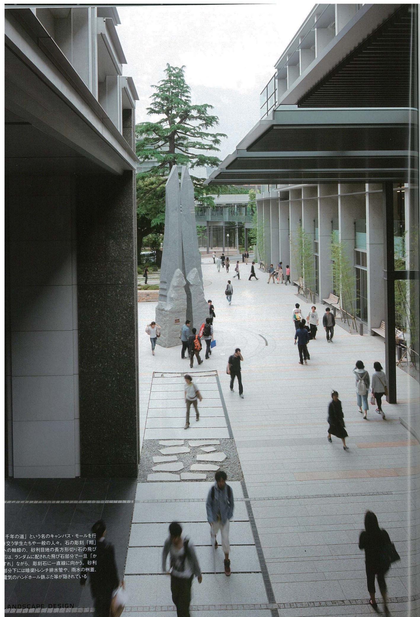
千年の道」という名のキャンパス・モールを行き交う学生たちや一般の人々。石の彫刻「翔」への視線の、砂利目地の長方形切り石の飛び石は、ランダムに配された飛び石部分で一旦「かたづけ」ながら、彫刻石に一直線に向かう。砂利部分下には暗渠トレンチ排水管や、雨水の樹蓋、電気のハンドホール鉄ふた等が隠されている
